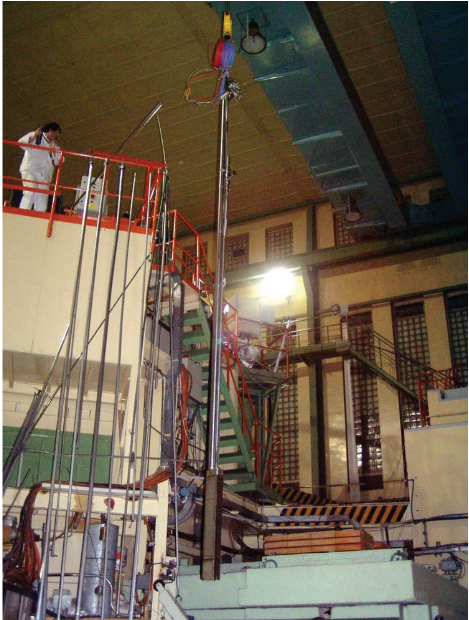
Vnitroreaktorová sonda TW3 pro testování teplotní a radiační odolnosti maket 1. stěny reaktoru ITER vyvinutá v ÚJV v letech 2002 až 2005 (archiv ČVŘ)
