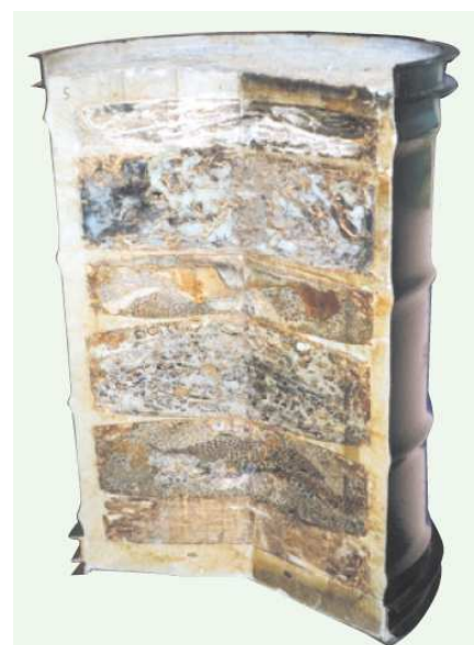
Řez sudem se zacementovaným odpadem
